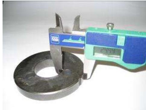
La mesure doit être faite sur les 3 patins d'embrayage, à 5 à 10 mm de l'extrémité de chaque patin (les 3 patins doivent être complètement fermés pour la mesure – pas d'ouverture).
