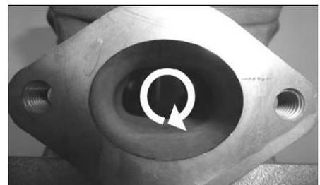
5.11 Sur le cylindre Junior Max evo (nouvelle technologie de fabrication), les dimensions horizontales et verticales du conduit d'échappement doivent être contrôlées avec le gabarit ROTAX 676240.
