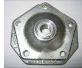
2.3 La hauteur de la culasse doit être de 28,80 mm avec une tolérance de +/-0,2 mm (H).
