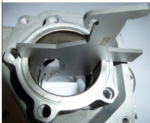
5.10 Le cylindre du moteur Junior Max evo (nouvelle technologie de fabrication) repéré d'une lettre dans la fonderie (par exemple "J") et dont le conduit d'échappement est usiné, **est autorisé**.
