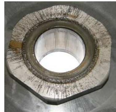
Les photos montrent le maximum de dépôt de graisse pouvant être centrifugé dans la cloche même avec le joint de cloche d'embrayage monté. Seul l'écrou de cloche et l'alésage du pignon montrent des traces de graisse. La surface de frottement des masselottes dans la cloche doit être complètement sèche.
