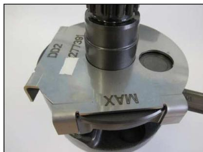
Repère MAX sur le gabarit pour les moteurs Max/J125 Max et Mini Max.
