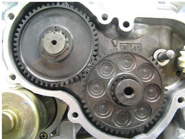
11.2 Les deux modèles de pignons de balancier aciers d'épaisseurs 6mm (mini 5.8mm) et 9 mm (mini 8.8mm) sont autorisés.
